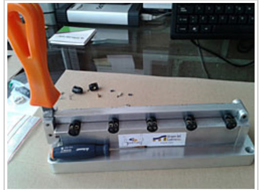
Dispositivo diseñado para facilitar el montaje de pilotos led.
