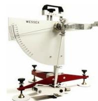
Por ello para todos los pavimentos se realizarán las medidas por el ensayo del péndulo, tanto en los ensayos de pavimentos nuevos como cuando se **renueven los certificados**. Los pavimentos se considerarán antideslizantes cuando el cálculo del valor de ensayo del péndulo resulte ser Clase 2 o Clase 3 de acuerdo con lo establecido en la tabla que a continuación se expone.
