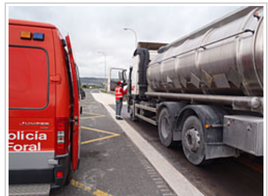
Merkantzien garraiorako ibilgailu baten pisu-kontrola.
