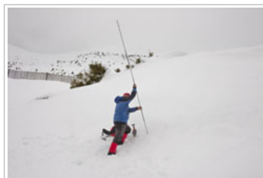
Medición del nivel de nieve para evaluar el riesgo de aludes.
