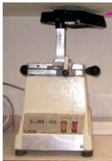
Máquina para termomoldeado de piezas dentales ➤
