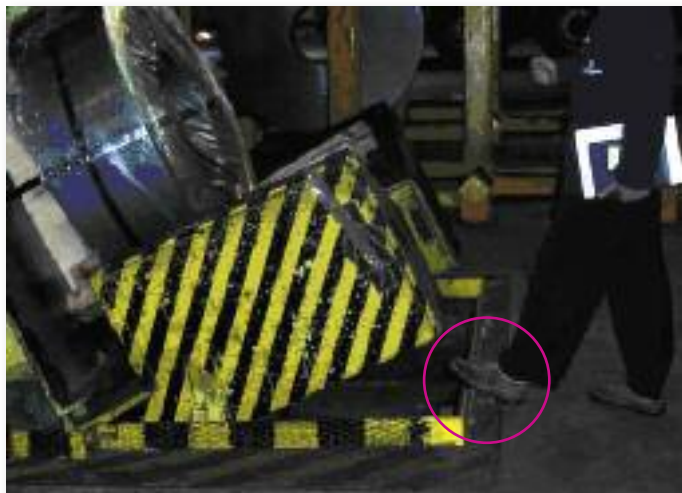
En el momento del accidente no existía el rodapié
