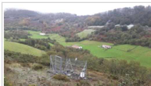
Pluviómetro colocado en el paraje Iñarbegi, en Erratzu (Baztan).
