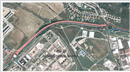
Desvío del tráfico durante el asfaltado de la calzada derecha.
