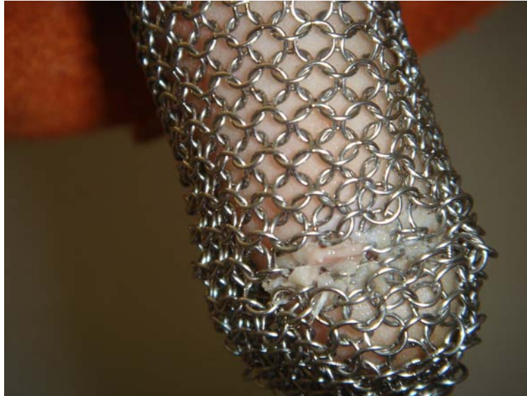
Figura 50. Detalle del corte muy profundo y de la malla incrustada.
