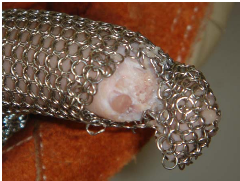
Figura 49. Detalle del "dedo" amputado y de la malla cortada.
