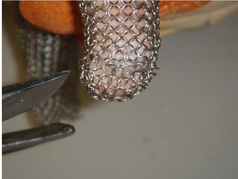
Figura 46. Detalle de un corte muy profundo y la malla incrustada.
