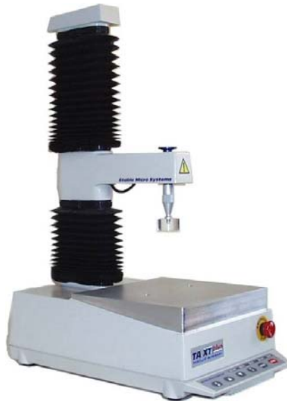
Figura 11.- Máquina Universal de Ensayos TA.XT2/25.
