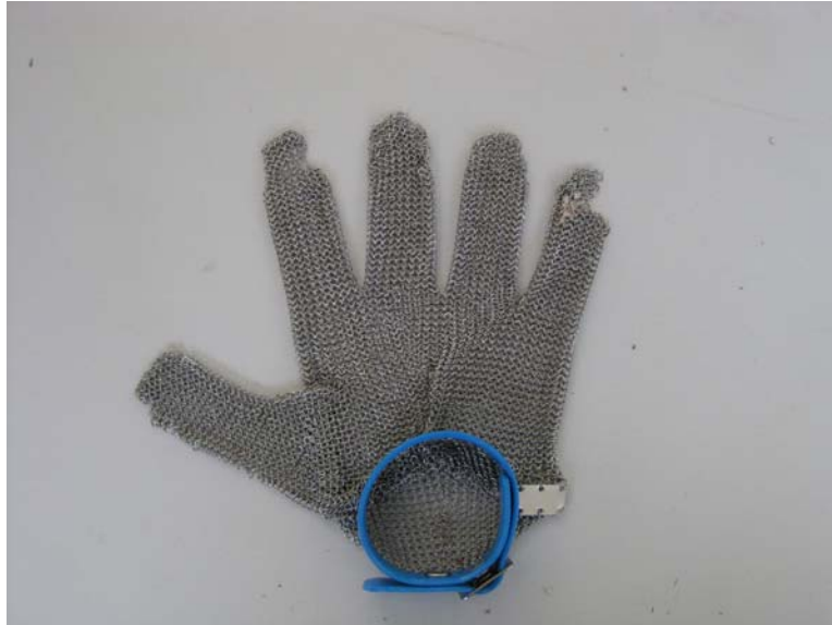
Figura 54. Estado final del guante utilizado en el ensayo.
