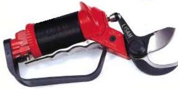
Figura 8. Tijera neumática utilizada en el ensayo.
