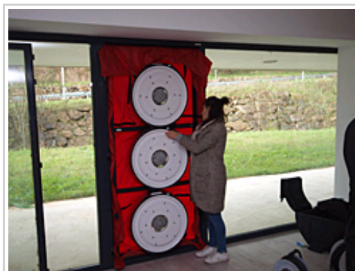
Una participante de las jornadas realiza la práctica de las pruebas BlowerDoor en la planta baja del edificio del centro lingüístico de Lekaroz.
