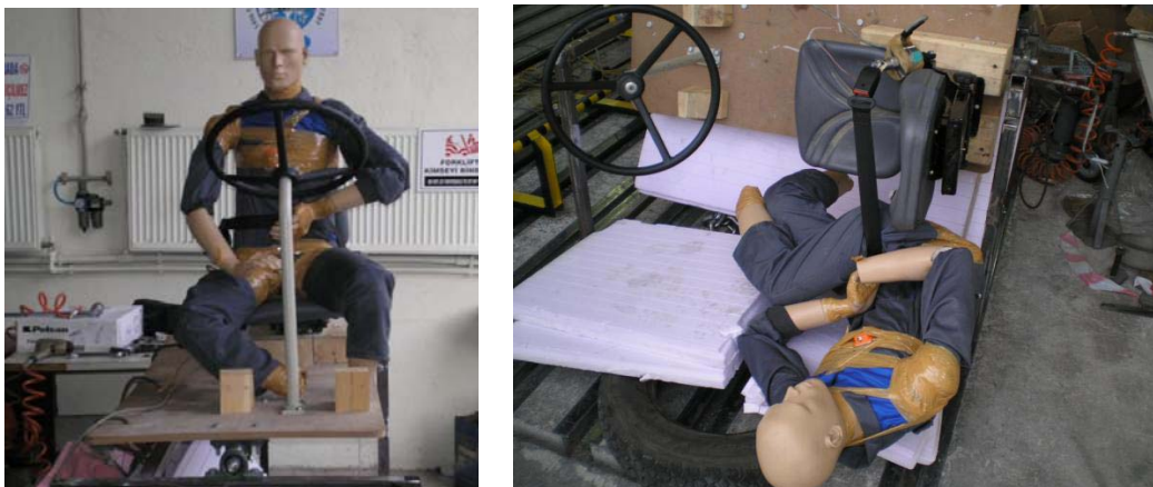
Figura 19. Ensayo de vuelco lateral
