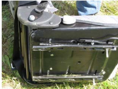
Figura 27. Guías dañadas del asiento D.
