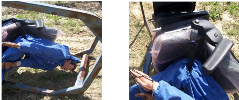
Figura 25. Resultado de sujeción del asiento B.
